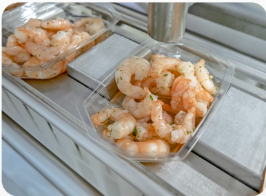
Walking Beam для жидкой продукции или лотков с трудными формами.
