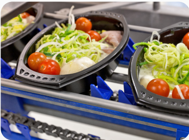
Конвейера с цепью и толкателями для высокоавтоматической последовательности.
