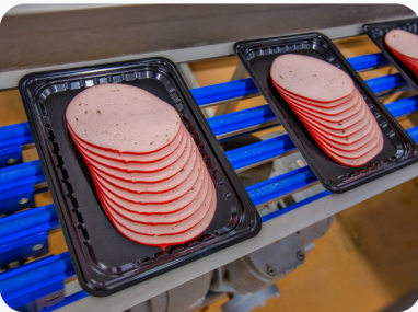
Поликордовые ремни для гибкости производственной линии.
